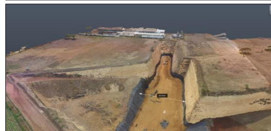
Nube de puntos resultado de un levantamiento fotogramétrico aéreo (drones)
