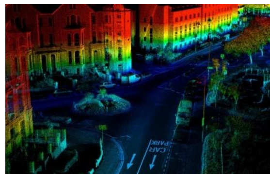
Registro laser a través de equipamiento de largo alcance
