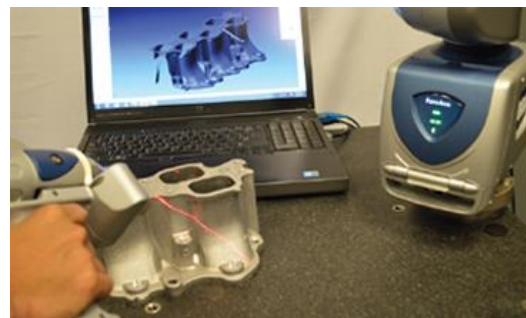
Registro láser de alta densidad, aplicaciones en el área de manufactura
