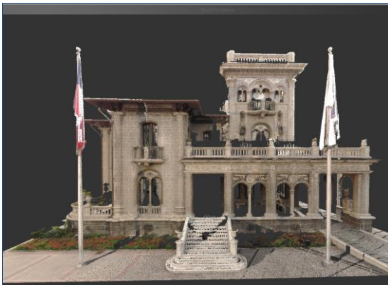
Levantamiento de formas orgánicas presentes en el edificio Falabella de la Municipalidad de Providencia, (Microgeo S.A).
