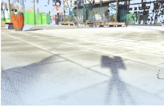
Integración de nube de puntos de entorno sobre ARCHICAD
