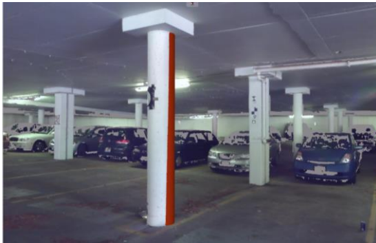
Integración de nube de puntos para trazar pilares sobre ARCHICAD
