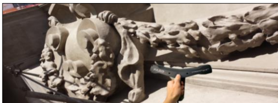
Registro láser manual aplicado a formas orgánicas https://www.youtube.com/watch?v=s1LZJHWNVTQ (link de demostración)
